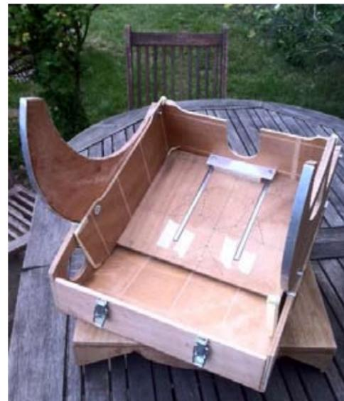
Avec les cales du miroir principal, du plat de protection et des tiges carbone .
