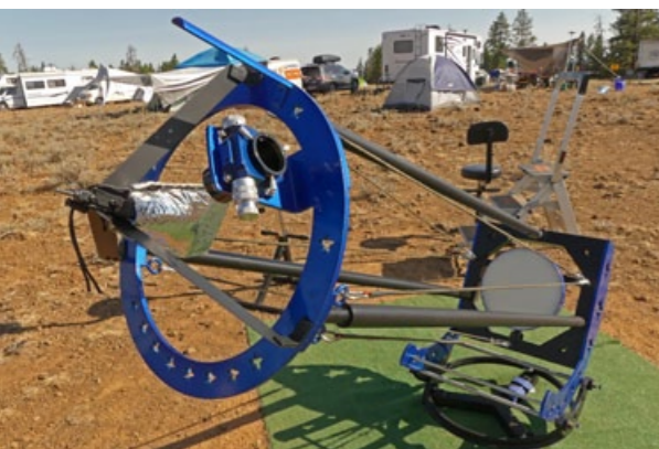
Une bien belle réalisation tout métal, mais au final une conception peu optimisée en termes de poids et de volume.
